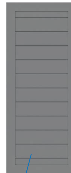
Rainurage horizontal épaisseur 30 mm
