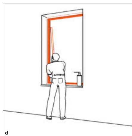
d L'ancien cadre en bois est ainsi recouvert des deux côtés, et donc protégé contre les intempéries. Le nouvel ouvrant peut alors être accroché.
